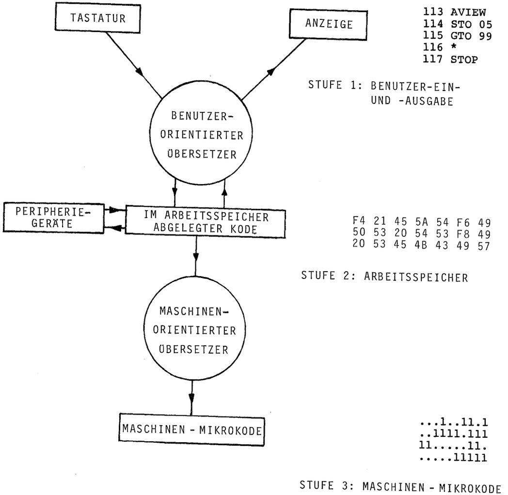
ABBILDUNG 2-1. DIE DREI STUFEN DER KODIERUNG IM HP-41C
