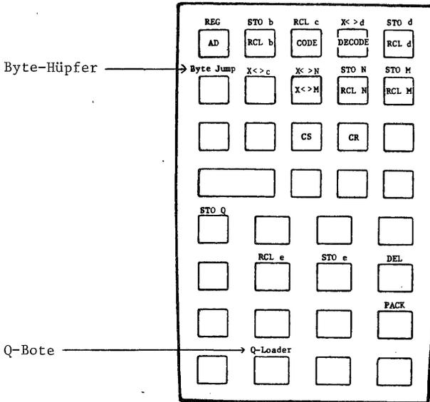
ABBILDUNG 5-1. EIN TASTENFELD FÜR DAS SYNTHETISCHE PROGRAMMIEREN
